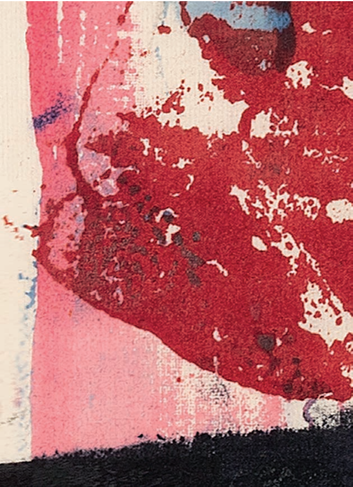
Stampa su supporto fibra di vetro con primer di finitura (resina impermeabilizzante) già applicato Printed on fiberglass support with finishing primer (waterproofing resin) already applied
